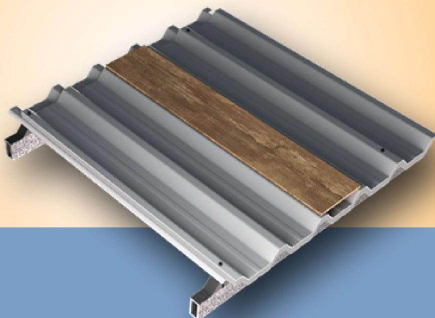
Para transporte e movimentação em cima das telhas, necessário utilização de passarela apoiada entre as terças, acima da viga, no sentido da caída da água.
